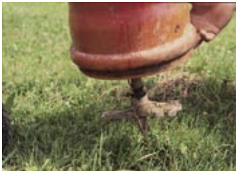
De freeskop heeft een doorsnede van 20 cm en draait met 1000-1800 toeren tot 15 cm diepte
