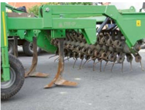
De kvik-up maakt distelwortels los met de diepwoeler en werpt deze nadien op met een aangedreven pennenrol.
